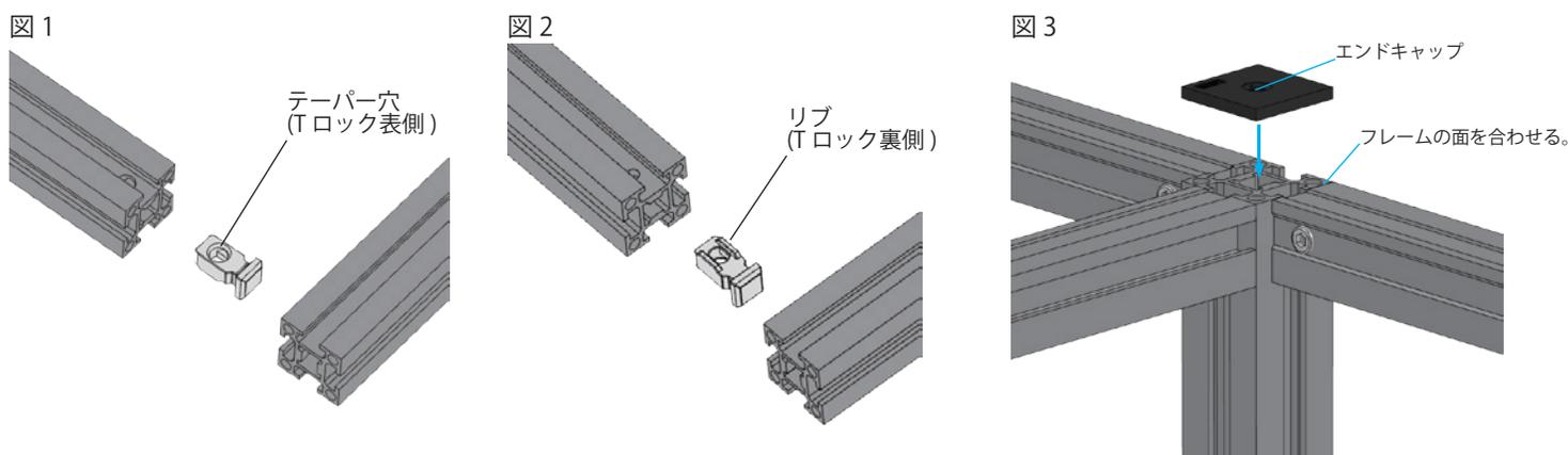
1. 図4-1 から図4-6 を参照し枠を組立てる。
