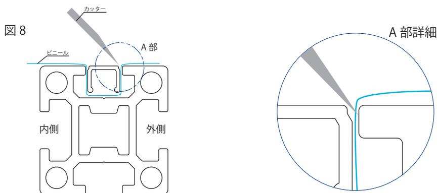
カッターを内側に倒し、刃先をフレームと溝カバーのすき間に入れて
